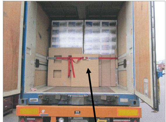
紙製ダンボールを挟んでラッシングベルトでコンテナ内のレールと緊締する
