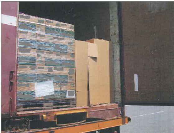
飲料パレタイズ貨物をストレッチフィルムで巻いて固定
