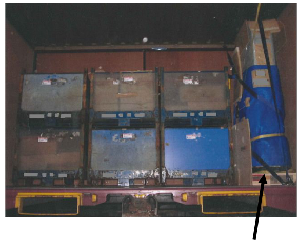
大型機械の重心をかんがえながらラッシングベルトで固定する
