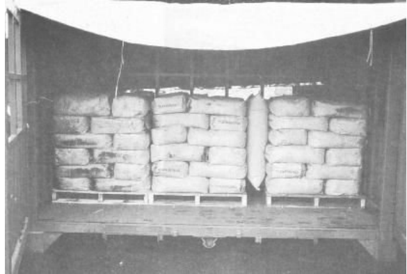
紙袋パレタイズ貨物の隙間をエアバックで埋めて固定
