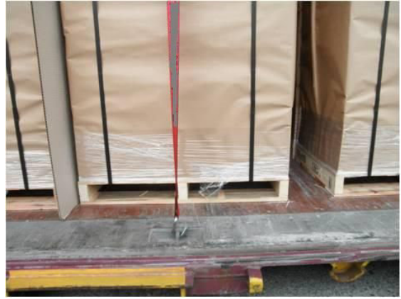
平判紙パレットとともにストレッチフィルムで巻いて固定
