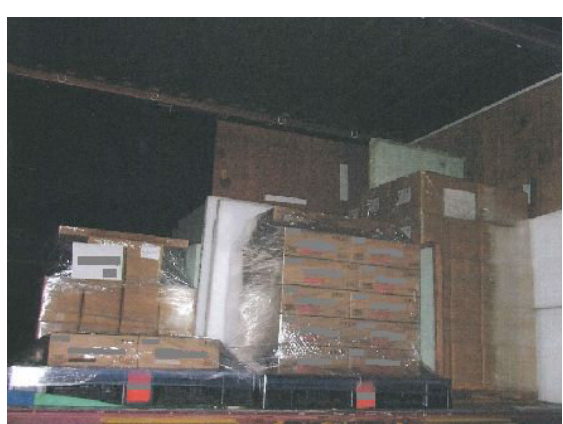
機械類ダンボール（不定形サイズ）をストレッチフィルムで巻いて固定
