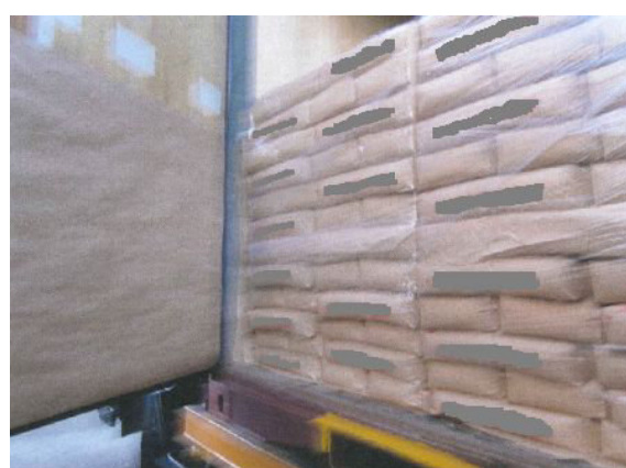
紙袋バラ積み貨物をストレッチフィルムで巻いて固定
