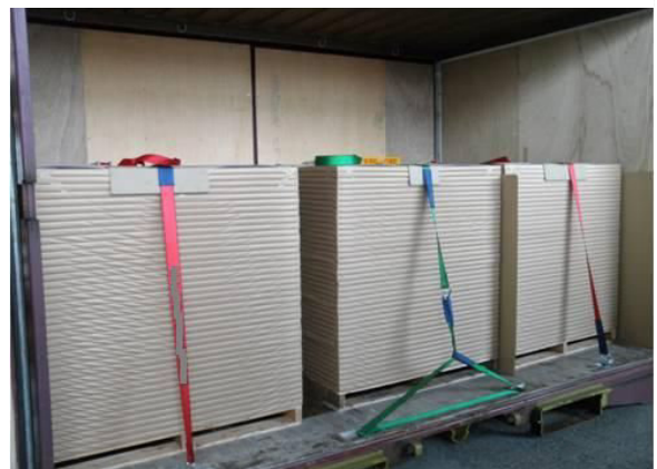
パレット積み平判紙をラッシングベルトでコンテナと緊締する
