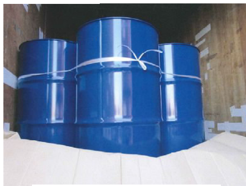
ドラム缶の下に巻き段ボールを敷く
