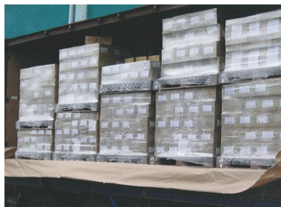
ダンボールパレタイズ貨物をストレッチフィルムで巻いて固定
