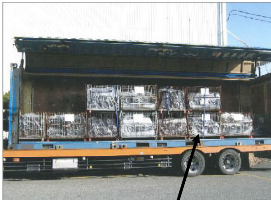
2段積みボックスパレットをラッシングベルトで緊締する
