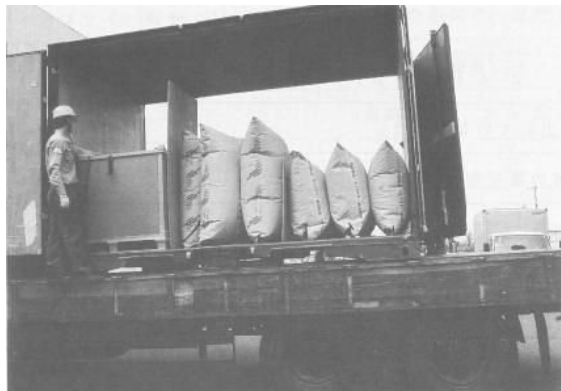
不定形貨物の隙間をエアバックで埋めて固定
