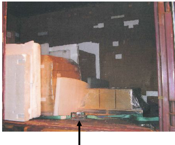
ストレッチフィルムで製品とパレットを一体化した後、パレットをラッシングベルトでコンテナと緊締する
