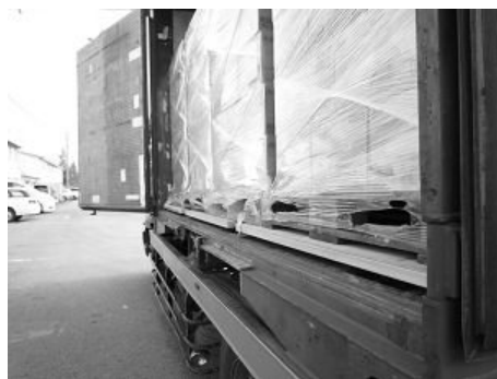
防振マットの上に荷物を積載した状態
