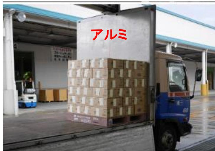
トラックのアルミボディーで電波が混乱
