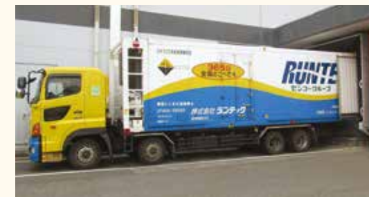
ドックシェルターに接車された31ft冷凍コンテナ
