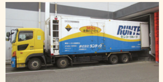
ドックシェルターに接車された31ft冷凍コンテナ
