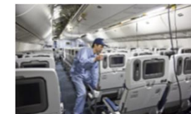
客室内椅子の取付・取外し
